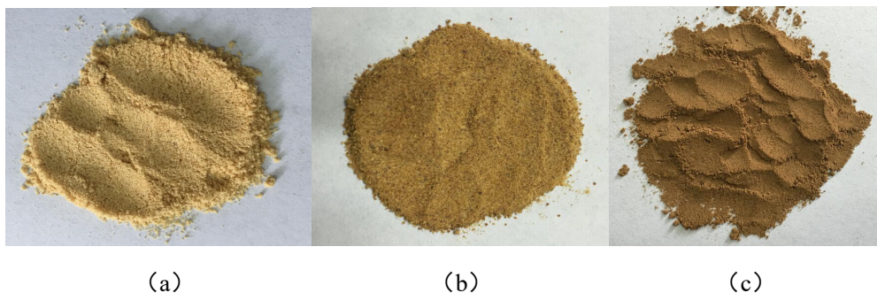
图 1 (a) 新鲜柚子皮粉；(b) 1#，碱改性柚子皮粉；(c) 2#， \text{FeCl}_3 改性柚子皮粉
